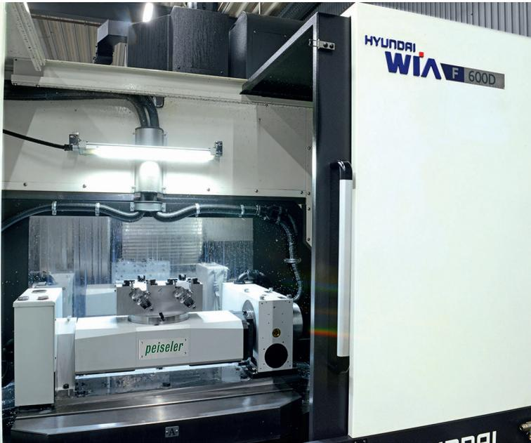
**1** Schwenkeinrichtung in der Werkzeugmaschine von Hyundai Wia bei Avci: Erstmals setzte Hersteller Peiseler mit dieser Lösung eine mittig platzierte Planscheibe um und realisiert damit einen größeren Störkreis © Peiseler
