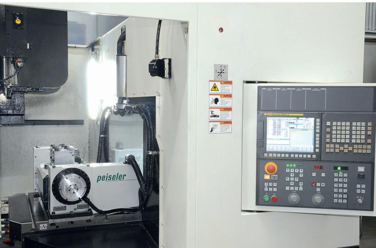
3 Die eine Hälfte des Wechseltisches mit einer der beiden Zweiachs-Schwenkeinrichtungen von Peiseler. Hinter der Scheibe ist die gerade im Maschinenraum positionierte Seite des Palettenwechslers zu sehen. Durch die hauptzeitparallele Spannungsmöglichkeit konnte Avci den Output um 20 Prozent steigern © Peiseler
